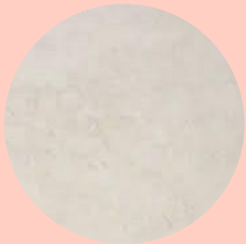
3 Capas. Rich, emparche y estuco. Acabado Exterior
