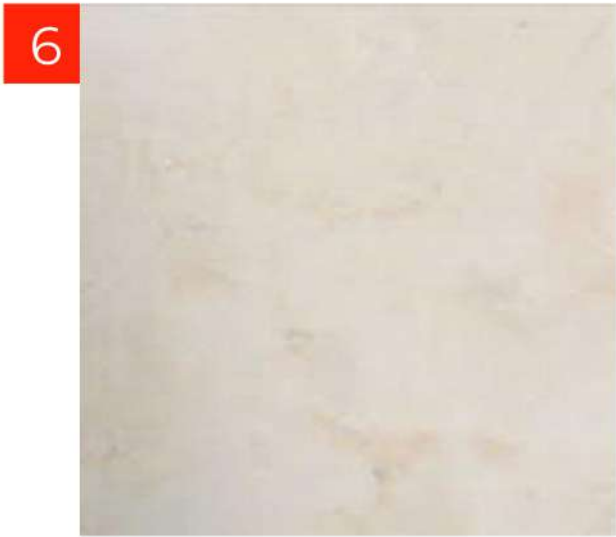
Tres capas: Rich, emparche y masilla pulida con pasta tipo chukum
