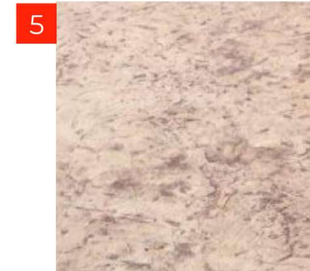
Concreto estampado, modelo Laja natural, con endurecedor Silver Gray y desmoldante light White.
