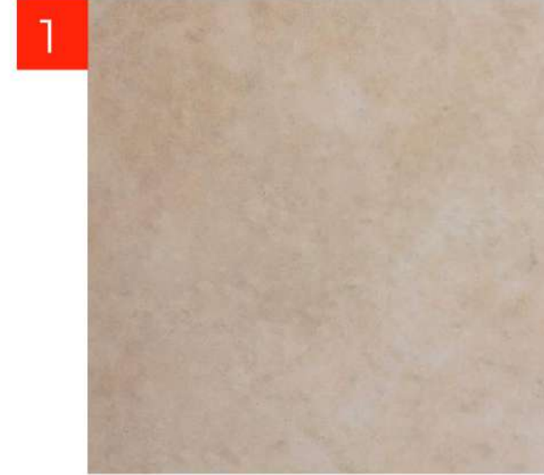
Dos capas: Rich y emparche con Pasta de kimplaster modelo chukum kp-60 marca: kimikolor
